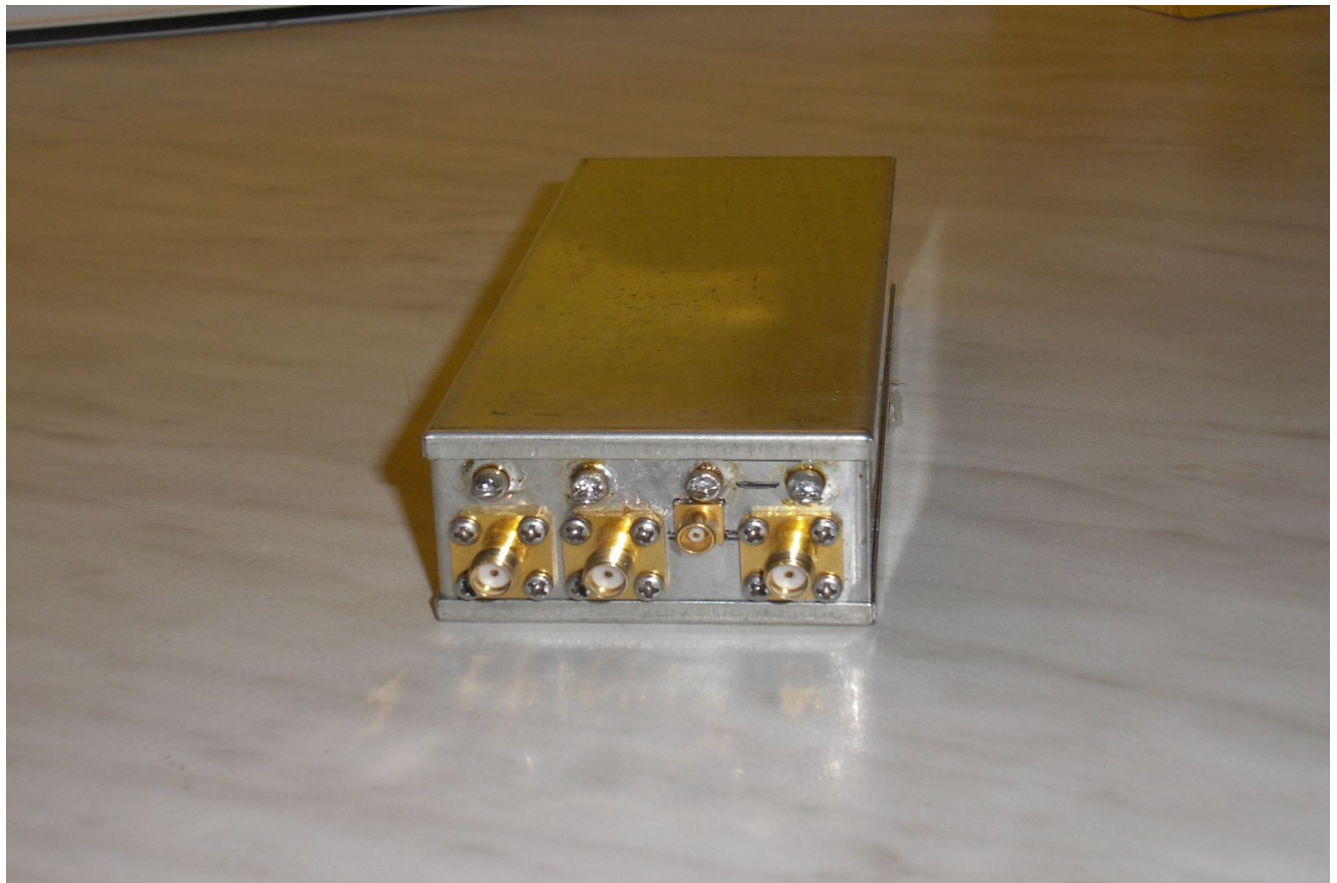
10GHz-Transverter mit neuer Buchse für GPS-Anbindung (HA8MV)
