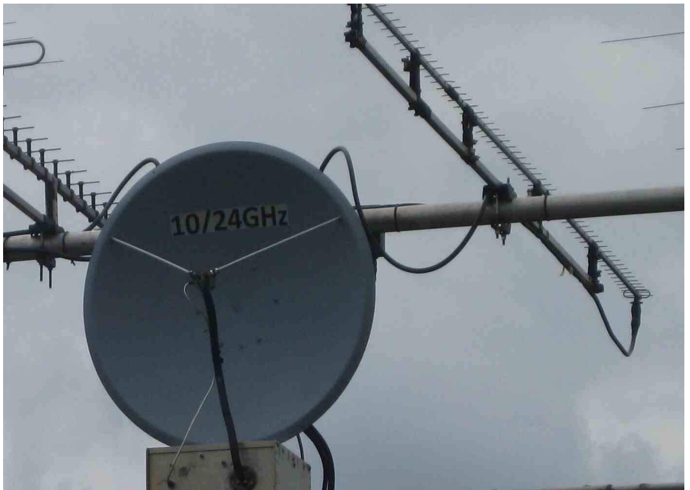
DM2EUN Tower mit Kombi-Spiegel für 10/24GHz in JO60IV
