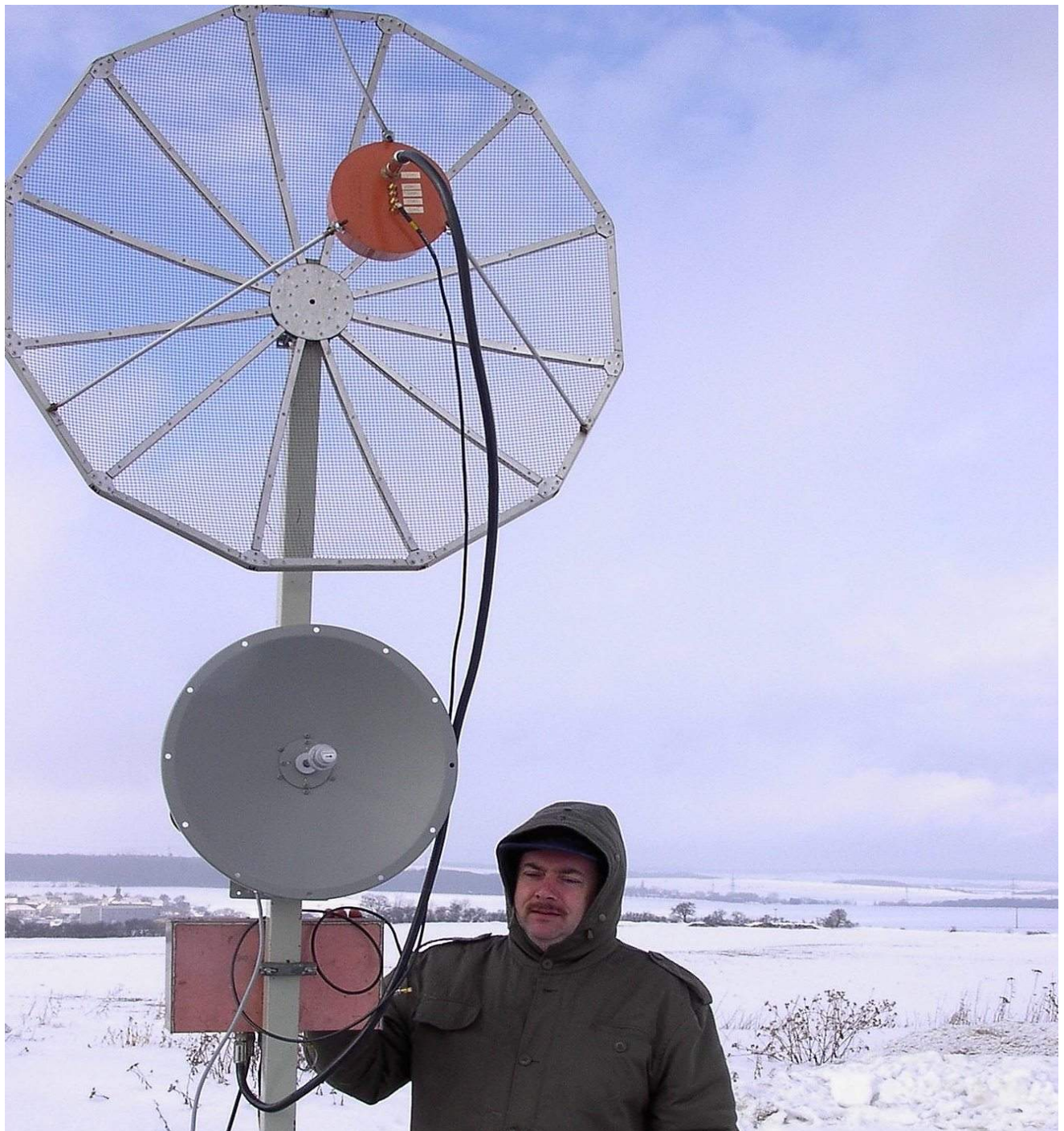
DL1ATI mit 6cm-Station, 23cm-Transverter (roter Kasten) und 1m-Spiegel für 23/13
