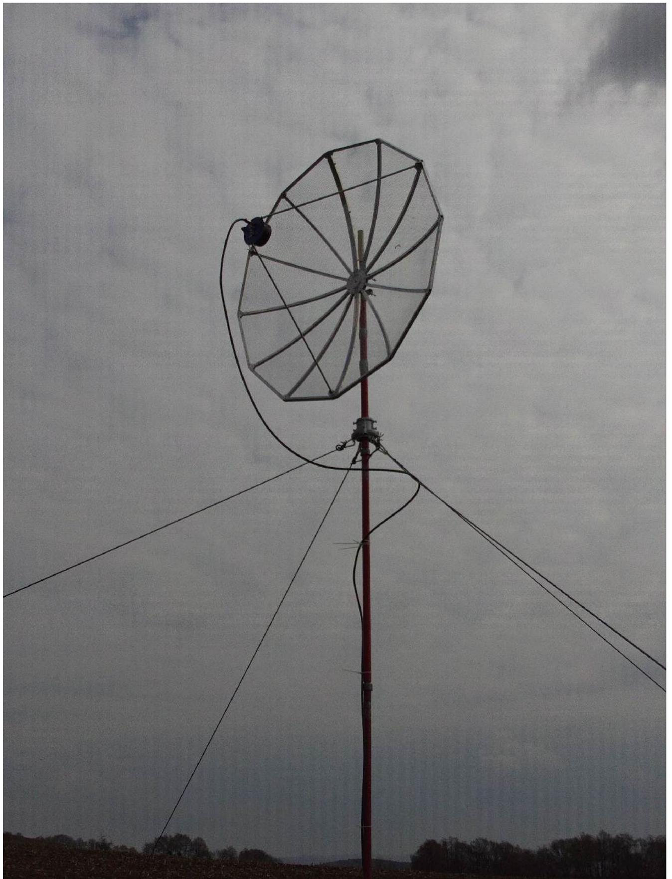
*Marios neue 23cm-Antenne (150cm DG0CN-Parabol)*
