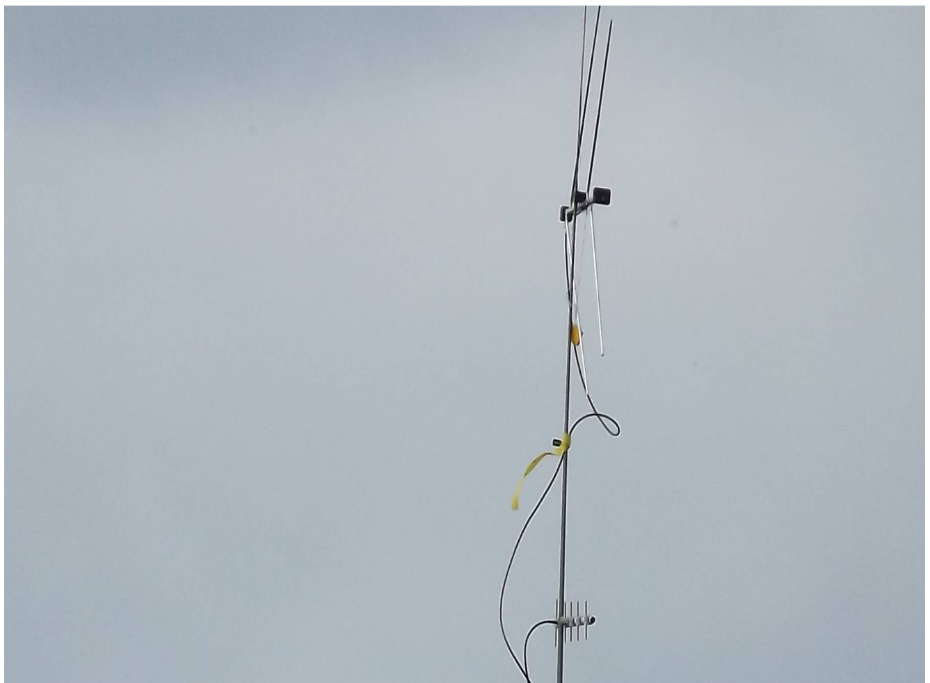
DL2HSC - aufgebaute Station auf der Oelsener Höhe, JO60XT, 644 m ASL oben LogPer 2m/70cm, darunter 23 cm Yagi, alles an 8 m Angelrute, nur 4 m ausgefahren. Yagi lässt sich hor./ver. drehen.
