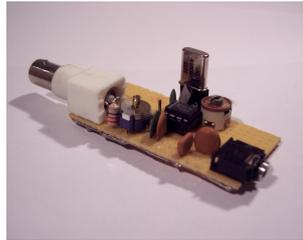
Abbildung 4.2: Mischer mit NE612, quartzgesteuert
